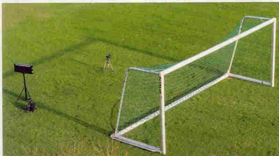
Drei Dinge braucht die Messung: Die Anzeigetafel, den Sensorknopf und Strom. Ein Tor muss nicht sein, es erleichtert dem Schützen den Job.
